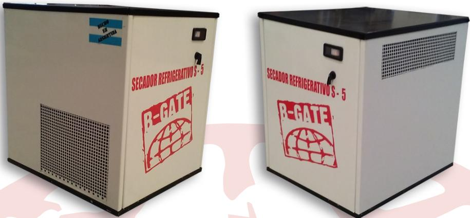
Secador de aire ciclo-refrigerativo, con indicador temperatura de aire, ciclado por presión de gas refrigerante, asegurando un punto de rocío estable en  $3^{\circ}\text{C}$ , ante las variaciones de temperatura ambiente, purga de condensado por medio de electroválvula con temporizador incluido. Gabinete con revestimiento epoxi al horno, refrigerante R-134. Caudales de  $0,5 \text{ m}^3/\text{min}$  a  $2,5 \text{ m}^3/\text{min}$  con temperatura ambiente hasta  $38^{\circ}\text{C}$ .
